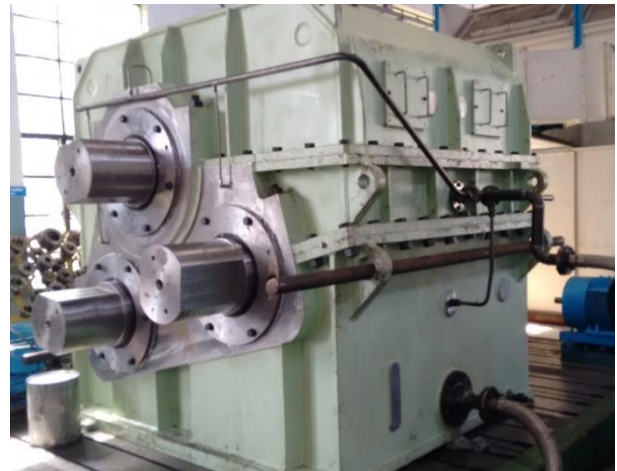
Beispiel: Makro- und Mikrogeometrie-Optimierung bei Zahnrädern für einen Pressenantrieb
