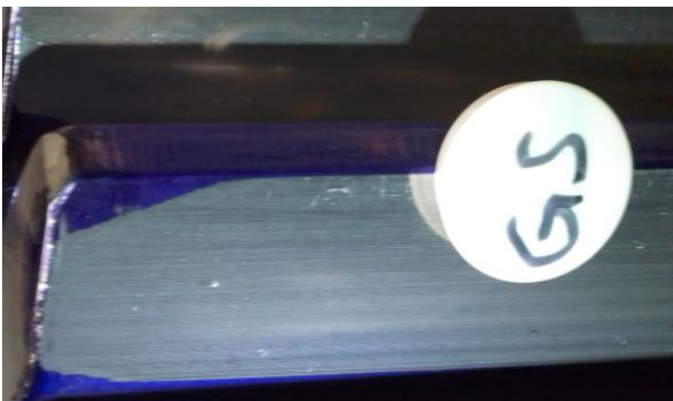
Beispiel: Bewertung von 3MW-Windgetriebekomponenten für die Zertifizierung nach GL-Richtlinie, Begleitung der Prüfläufe, Tragbildbeurteilung
