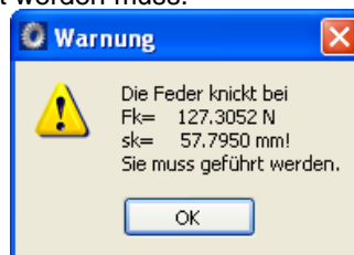
Abbildung 2.2 Warnung, falls die Feder knickt und geführt werden muss
