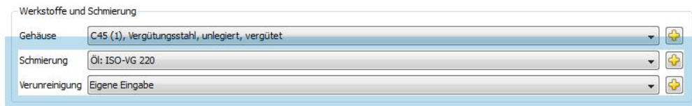
Abbildung 1.9 Gruppe ‚Werkstoffe und Schmierung‘ im Tab ‚Basisdaten‘ mit Schmierungsparametern Schmierung: Die Wahl des Schmierstoffs hat Einfluss auf den Lebensdauerbeiwert.
