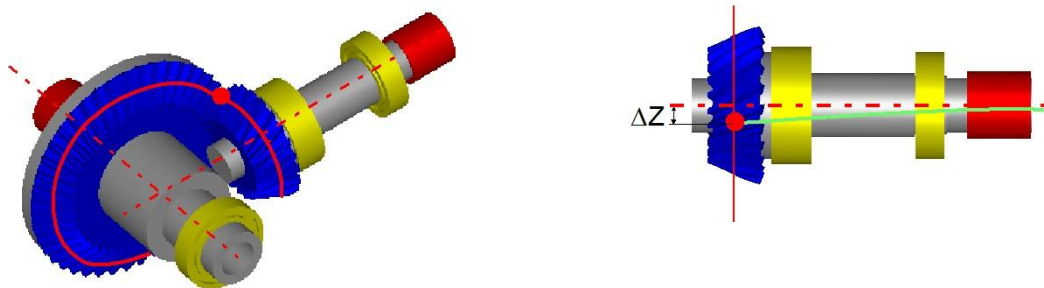
Abb. 6: Bezugssystem im Kontaktpunkt und Berechnung der Komponenten.
