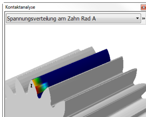
Bild 5a: Unkorrigierte Verzahnung
