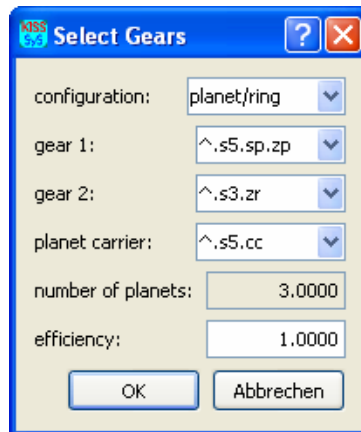
Planetensatz, Verbindung zwischen Planet zp und Ring zr
