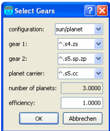
Planetensatz, Verbindung „sp“ zwischen Sonne zs und Planet zp
